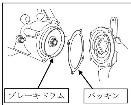
(4) 元のようにバックプレートを組付け、ブレーキアームに矢印方向の力を掛けながら取付ボルト (M6) 4本締め付けます。
