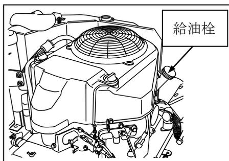
(5) エンジンオイル給油後、オイルがにじみでないように、給油栓はしっかりと締付けてください。
