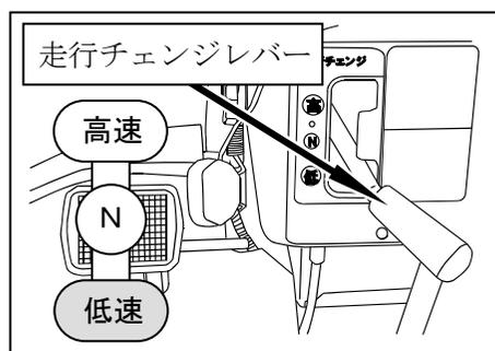
**重要** ● 草刈作業は走行チェンジレバーを「低速」にして行なってください。「高速」での作業は、エンジン・トランスミッションに大きな負荷がかかり、故障の原因となります。
