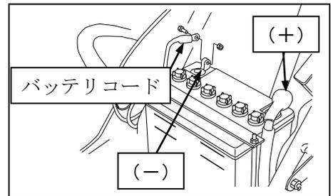
(3) バッテリーを固定しているプレートを外して、バッテリーを本機から取り出し、充電を行なってください。
