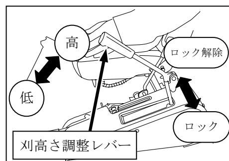
刈高さが高いときにレバー上部を上に引っぱり前に倒すと、レバーの高さを低くできます。レバーが枝に引掛りにくくなります。
