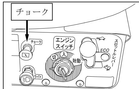
(9) エンジンスイッチにキーを差し込み、「始動」の位置まで回し、エンジンを始動させてください。
