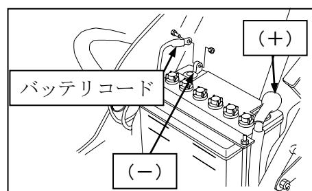
(3) バッテリを固定しているプレートを外して、バッテリを本機から取り出し、充電を行なってください。
