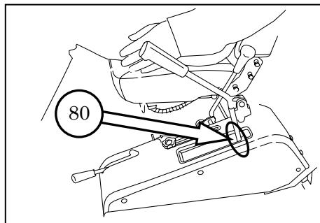
**重要** ●刈高さ調整レバーを操作する際は、必ずレバーを座席側へ傾け「ロック」を解除してから上下操作をしてください。「ロック」を解除しないで無理に操作すると故障の原因となります。
