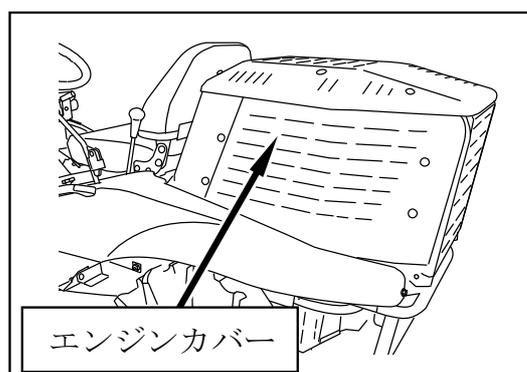
(1) シートを前方に倒し、シート下、左後ろ隅のノブボルトを外してください。
