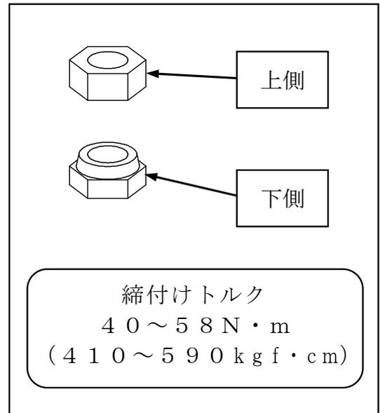
**危険** ●上下のナットを同時に締付けしないでください。ナットの締付力が不足し、ナットの緩みが発生します。その場合、刈刃が飛散し、周囲の人や物に当り、重大な事故を招く恐れがあります。
