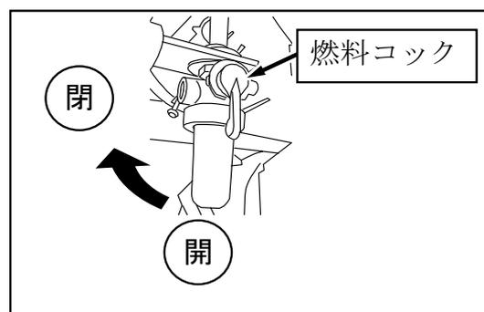
(4) 万一、故障等により、エンジンスイッチを「切」位置にしてもエンジンが停止しない時は、燃料コックを「閉」位置にして、エンジンが停止するまで監視してください。
