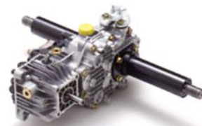
HST (10cc×1) 一体型 T/M ・ 5.5 馬力入力・爪式サイドクラッチ
